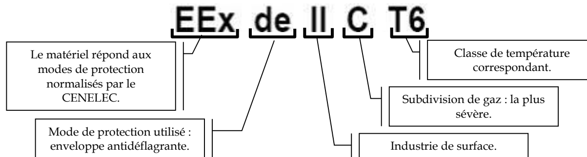
Figure 14 : Exemple de marquage ATEX (appareil électrique)
